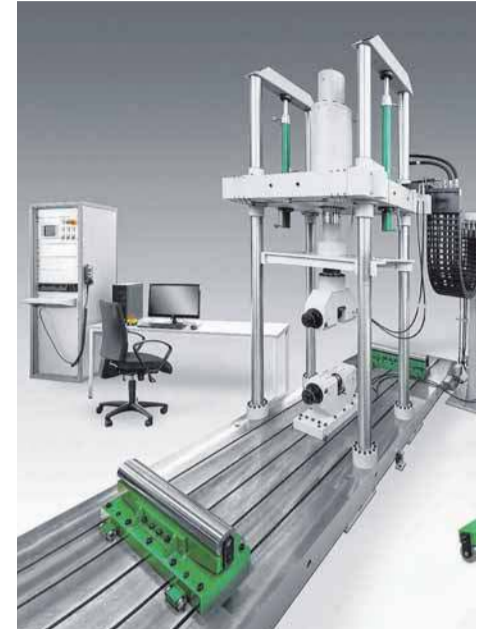
Eine Druck- und Biegeprüfmaschine zur Prüfung von Betonproben (l.). Prüfportal für universelle Versuchsdurchführung bei großen und stark unterschiedlichen Probeabmessungen (r.).
